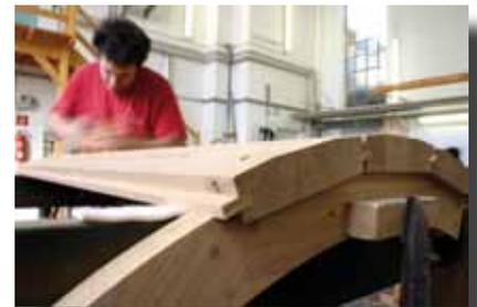
Arbeiten am Orgelgehäuse, die verleimten Eichenbretter werden rund gehobelt, um einen Gehäuseturm zu bilden
